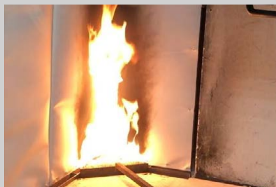
↑ A2-s1,d0 Brandschacht-Brenntest beweist die nicht brennbaren Eigenschaften
